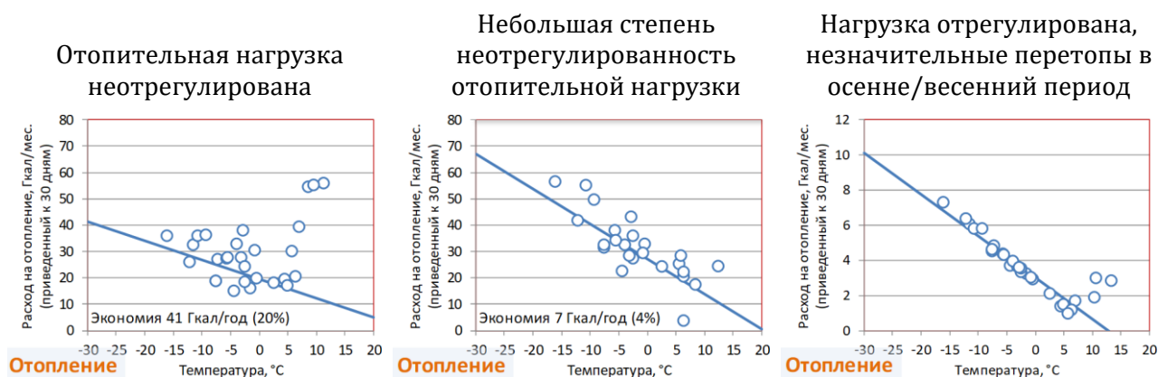
Рис. 9. Примеры фактических затрат на отопление в зависимости от среднемесячной температуры наружного воздуха
