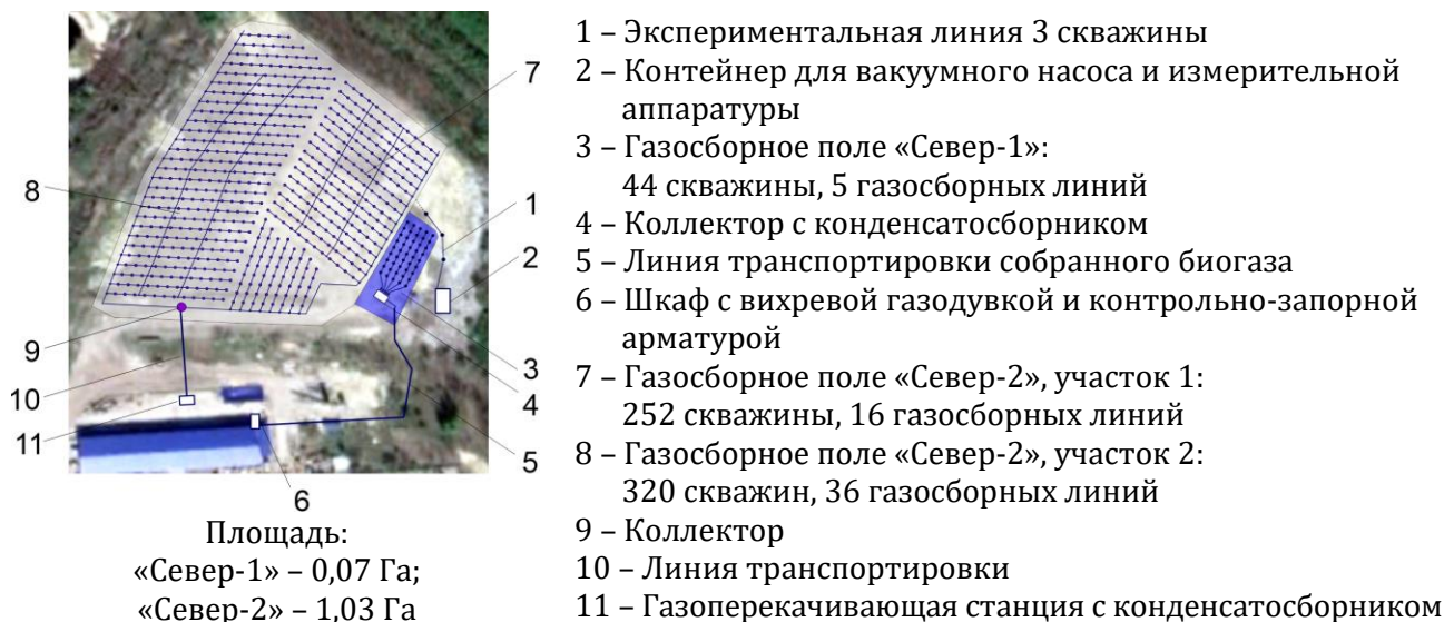
Рис. 8. Газосборные поля на северной части полигона ТКО
