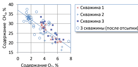
Рис. 7. Зависимость между содержанием метана и кислорода (экспериментальная линия «3 скважины»)
