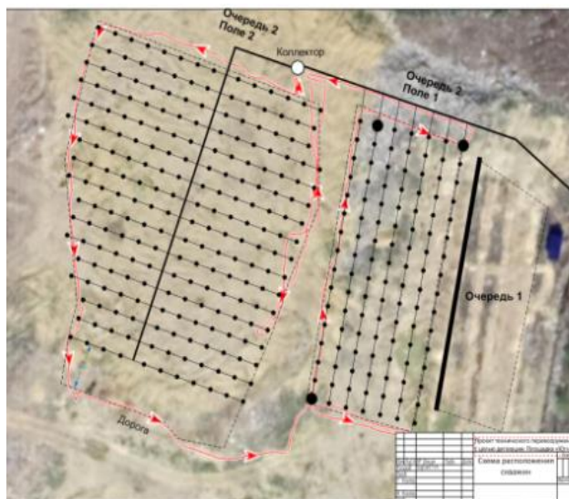
Рис. 6. Пример реализации газосборных полей
